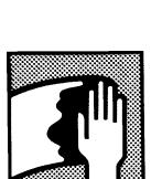
Inaintea inceperii lucrarilor de pregatire, spalati toate suprafetele cu o solutie de sapun cu apa. Clatiti si lasati suprafata sa se usuce inainte de a degresa substratul cu o solutie de curatare de la PPG.
